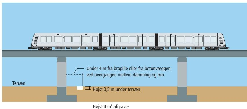
Der må højst udgraves  $4 \text{ m}^3$  på samme tid og på samme side af metroens centerlinie. Der kan dog udføres flere samtidige udgravnninger på samme side af centerlinien, hvis afstanden mellem dem er større end 20 meter. Der må ikke graves dybere end 0,5 meter under terræn.
