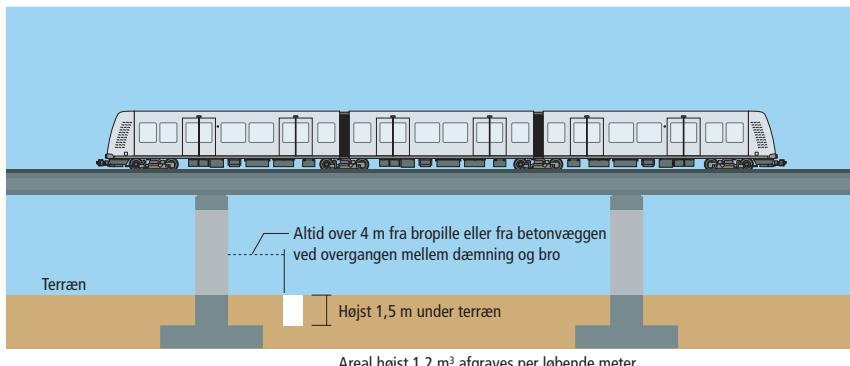
Afstanden fra nærmeste bropille eller fra betonvæggen ved overgang mellem bro og dæmning skal altid være mindst 4 meter. Det udgravede areal må højest være  $1,2 \text{ m}^2$ , og der må kun graves til 1,5 meter under terræn. Der må højest udgraves én rende mellem to bropiller på samme tid. Hvis der skal graves flere render, skal den første rende altså opfyldes, inden udgravningen til den næste påbegyndes.
