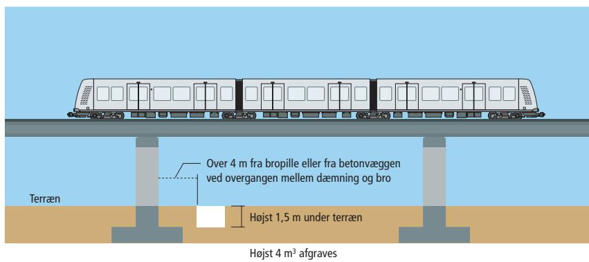
Højst  $4 \text{ m}^3$  må udgraves på samme tid og på samme side af Metroens centerlinie. Der kan dog udføres flere samtidige udgravnninger på samme side af centerlinien, hvis afstanden mellem dem er større end 20 meter. Der må ikke graves dybere end 1,5 m under terræn.
