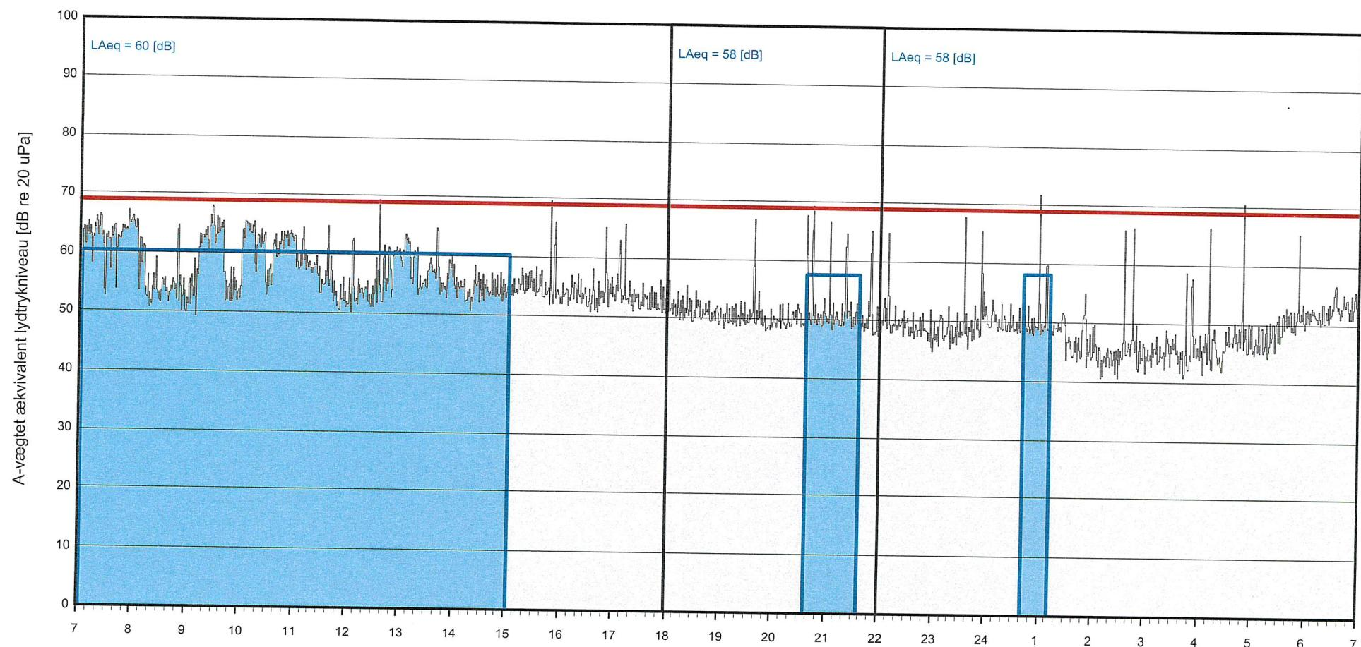
Den grå kurve viser det registrerede lydtrykkniveau L<sub>Aeq</sub> pr. 1 min.
