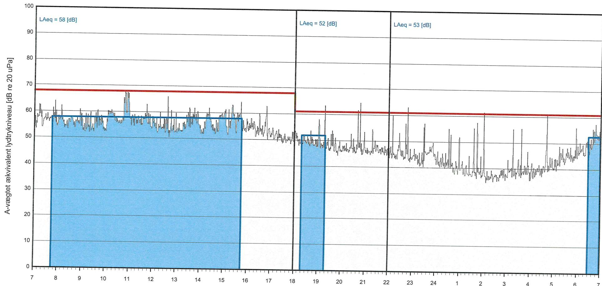
Den grå kurve viser det registrerede lydtrykniveau L<sub>Aeq</sub> pr. 1 min.
