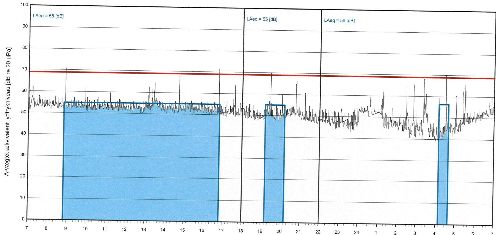
Den grå kurve viser det registrerede lydkniveau LAeq pr. 1 min.
